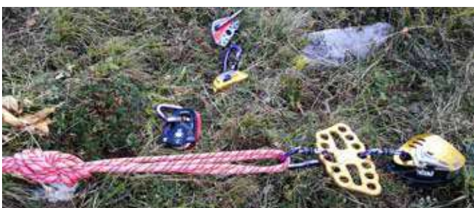
Le Maestro : un appareil de mouflage qui démultiplie la force des sauveteurs.
